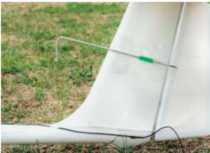
Ein behelfsmäßiger Einbau der TEK-Düse ist nicht exakt genug ...
