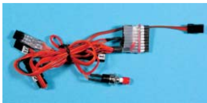
der Kabelbaum kann fest ins Modell eingebaut werden – die Module werden dann nur noch angesteckt
