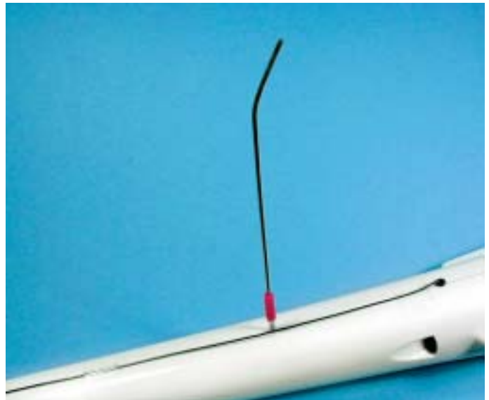
... erst ein Festeinbau der TEK-Düse brachte eine zufriedenstellende Kompensation
