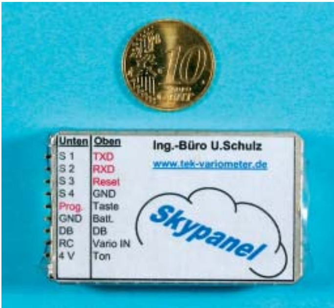
Der SKYPANEL Zentralbaustein hat's ganz schön in sich – wiegt aber gerade einmal 30 Gramm
